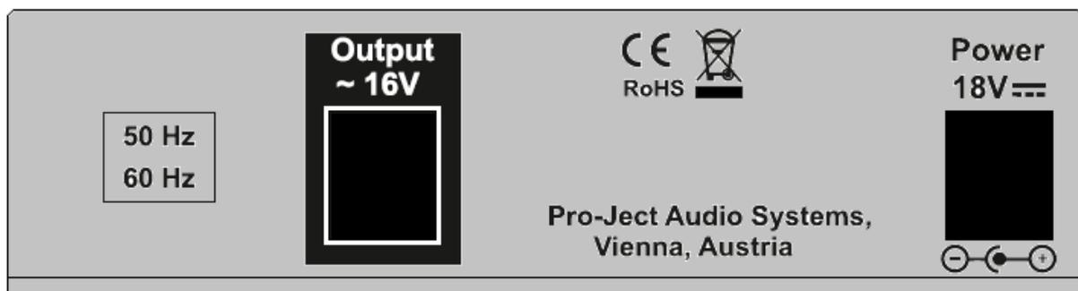
Verbinden Sie mit dem beiliegende Versorgungskabel \*\*\*die Buchse Output ~ 16V und die Netzteilbuchse Ihres Plattenspielers. Das vorhandene AC- Steckernetzteil des Plattenspielers wird nicht mehr benötigt.
