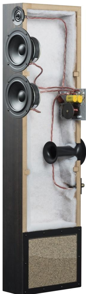
Das 19 Millimeter dicke Gehäuse sorgt für hervorragende Festigkeit und verhindert das Rausdringen des Schalls. Das Innenleben des Lautsprechers ist so einfach wie möglich gehalten. Das PCB-lose Design garantiert einen ungestörten Signalweg zu den Treibern.
