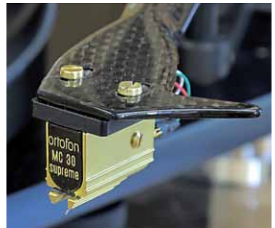
Als „Tausch-Objekt“ erbt Ortofon's MC 30 Supreme (r.) den Platz am Carbon-Tonarm des Perspex Anniversary vom just ausgelaufenen Valencia (u.). Das Klangniveau bleibt dabei erhalten
